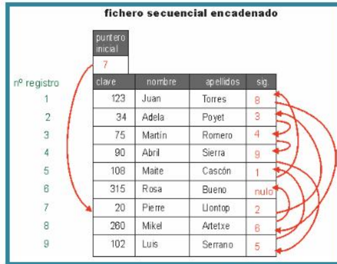
Ilustración 2, ejemplo de fichero secuencial encadenado. Los punteros le recorren por la clave
