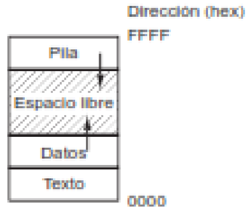
Figura 1-20. Los procesos tienen tres segmentos: de texto, de datos y de pila.
